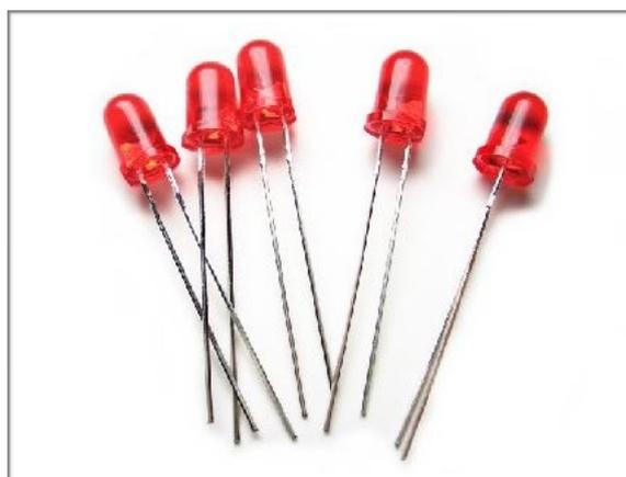
Le principe de fonctionnement est basé sur des électrons occupant certains espaces dans un matériau semi-conducteur et libérant de l'énergie, ou des photons. Les différentes fréquences et couleurs émises dépendent des matériaux. La LED a besoin d'un courant constant pour être alimentée, c'est la raison pour laquelle elle va toujours avec une résistance qui permet de contrôler le flux électrique qui atteint la diode.
